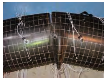
曲げ変形で破壊したラインパイプ
